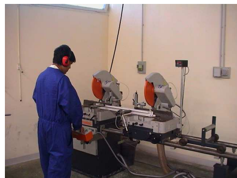
Débit des profilés sur machine
