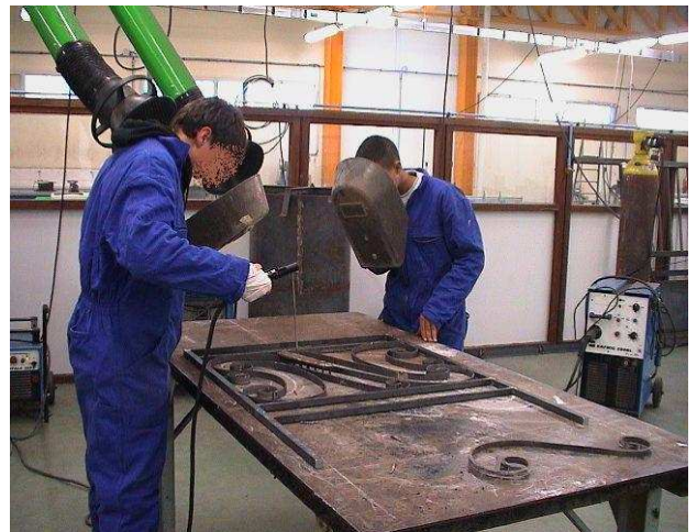
Soudage d'un portail
